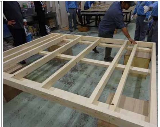
4. 奥壁用運搬木枠の作成状況
