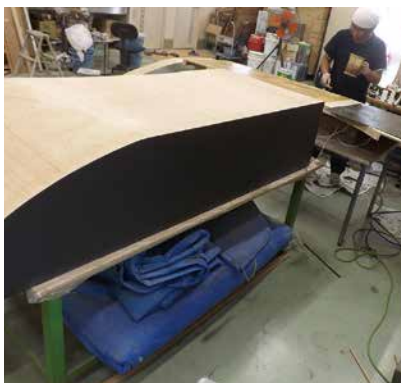
10. 【工程 9-(6)】 化粧板貼り付け (側面)
