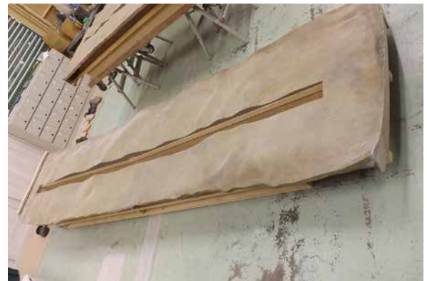
9. 【工程 9-(5)】 樹脂成型品への彩色 (床)
