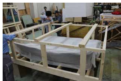
3.【梱包】梱包用木枠組み立て作業3
