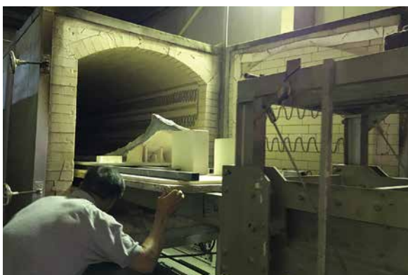
7. 【工程 10-(2)】作業工程⑭: 焼成
