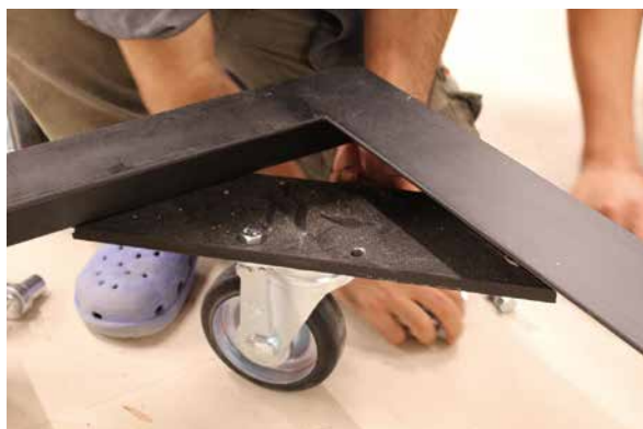
3. 【手順 2-②】 移動用キャスター取付け作業状況 1
