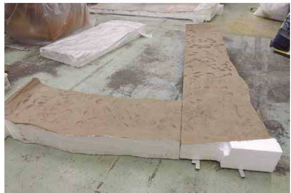
8. 【工程9-(1)】砂と顔料を混ぜたものを塗布(天井)
