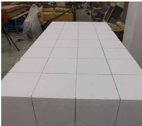
1. 【工程9-(1)】使用する原材料に線描き
