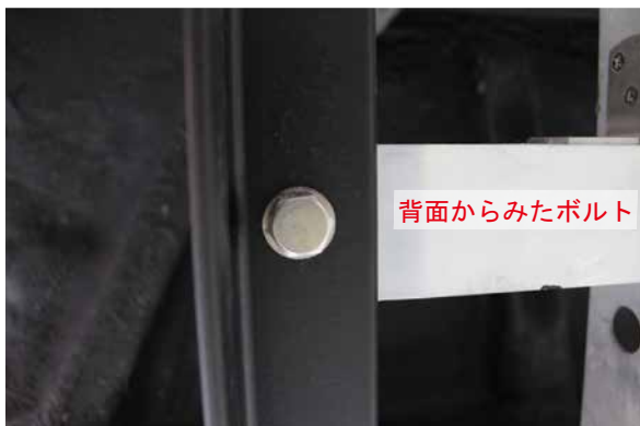
5. 【手順 3-④】奥壁取外し注意箇所 2
