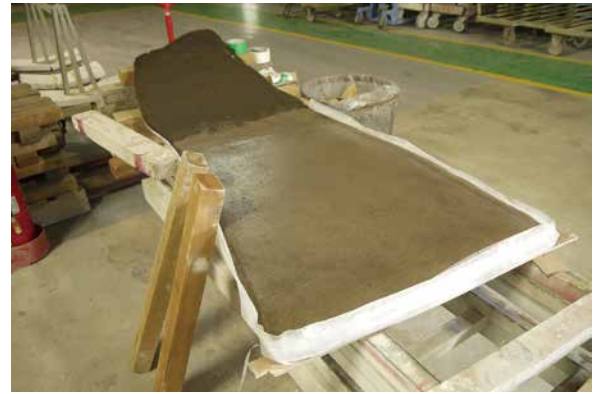
2. 【工程 10-(2)】作業工程⑤: レリーフ部の成形
