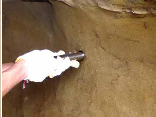
第33図 山中式土壌硬度計による硬度計測
