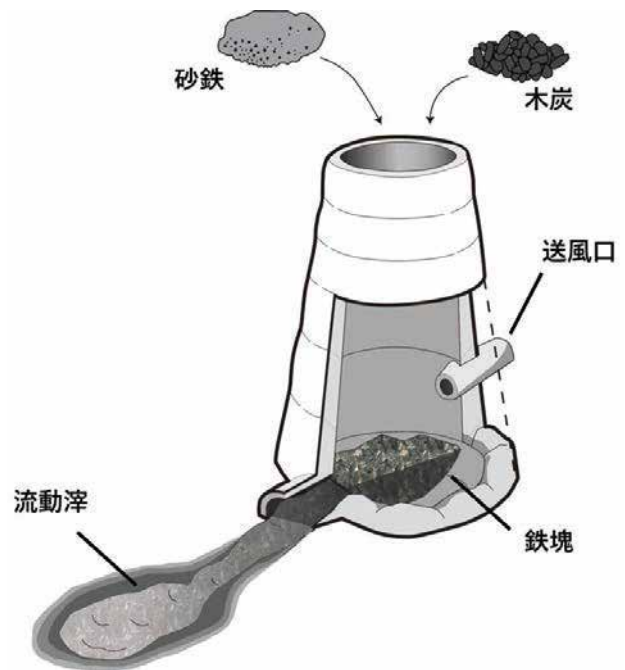
第5図 円筒形自立炉模式図
