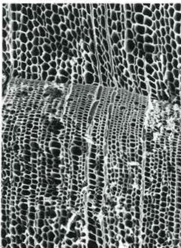
5a ネズコ(横断面) 破片仮No.5 bar:0.5mm
