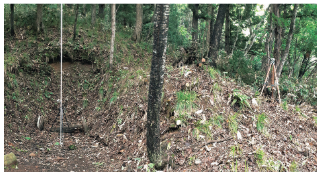
図4 オートレベルによるターゲットマーカーの水準計測
