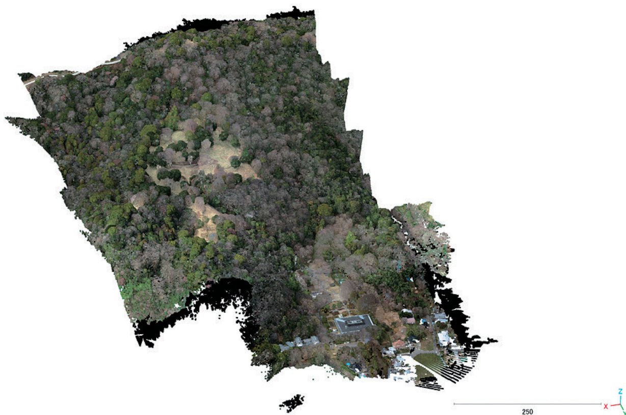
図1 特別史跡岩橋千塚古墳群前山A地区 UAV搭載LiDARによるオリジナル点群データ（北東方向より）
