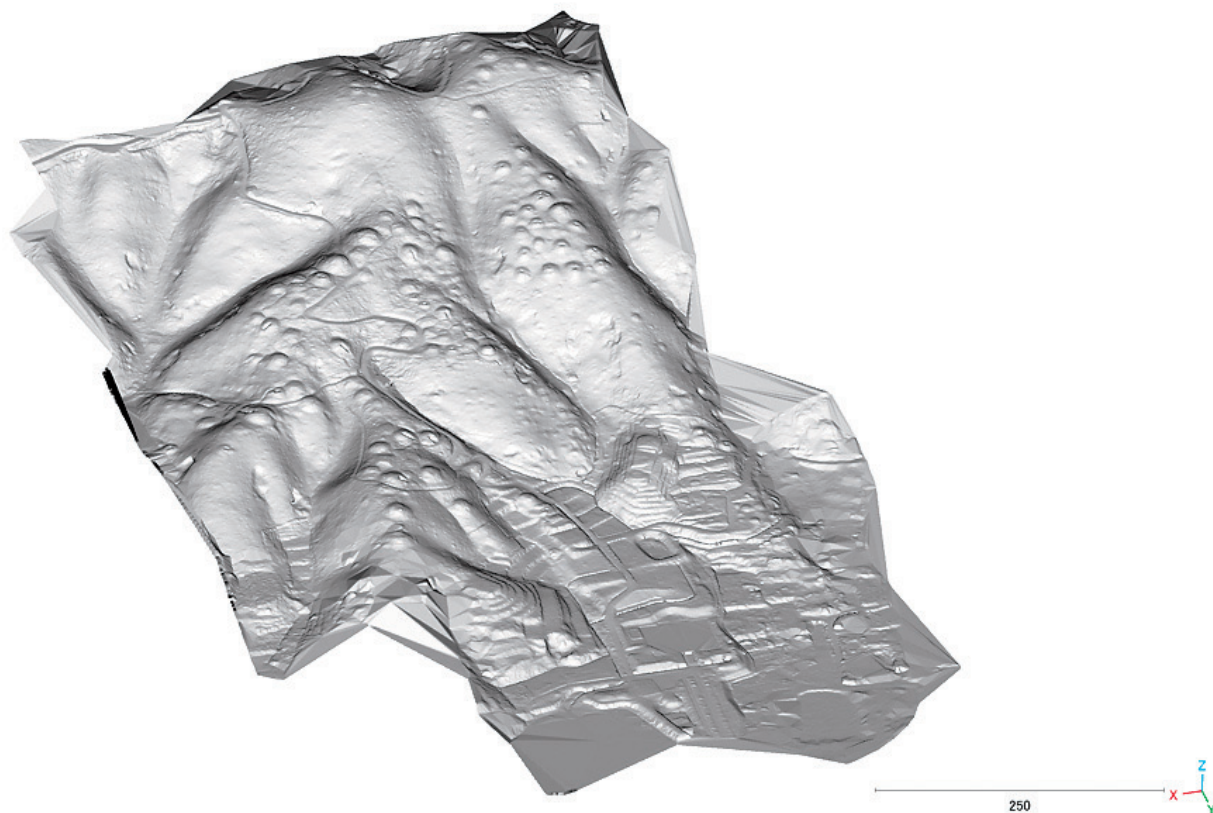
図2 特別史跡岩橋千塚古墳群前山A地区 UAV搭載LiDARによるグラウンドデータ（北東方向より、CloudCompareによりメッシュ化したもの）
