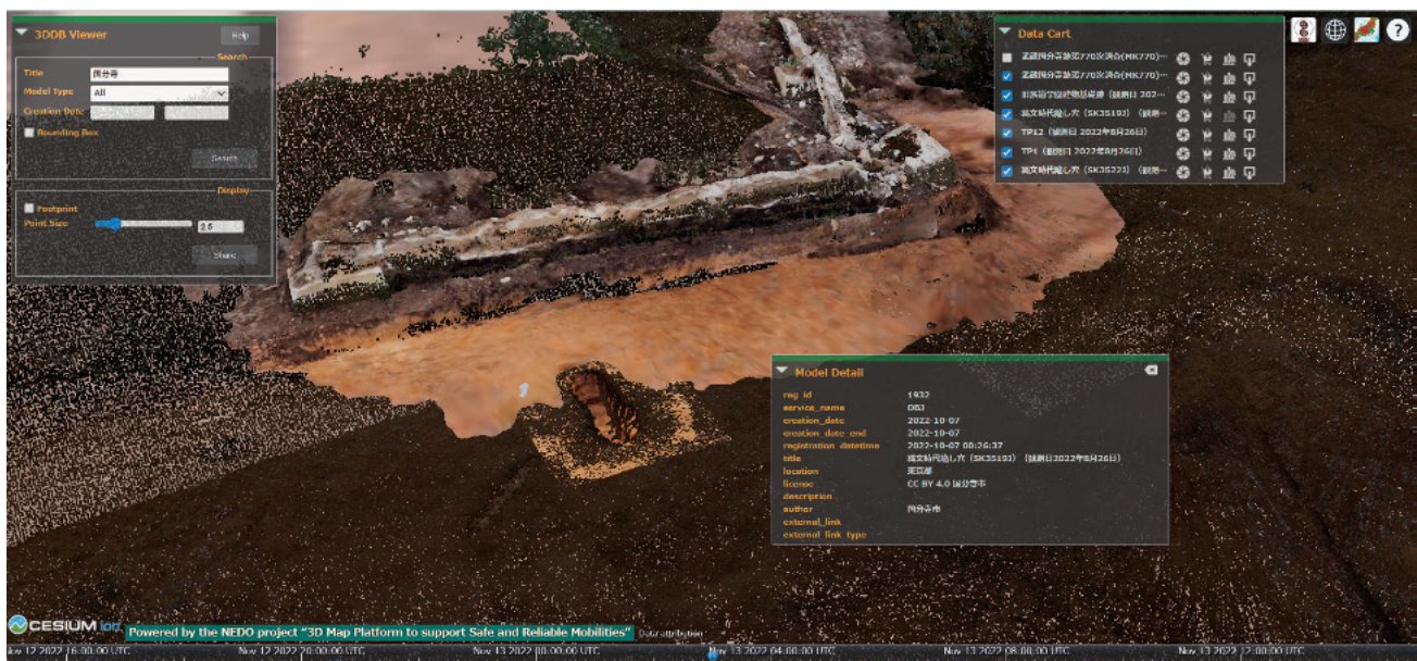
図6 国分寺市役所新庁舎建設地点（国分寺市2022）の地下遺構（全国文化財デジタルツインプラットフォーム） 調査区全体：手持ち型スキャナー（Leica BLK2GO）、縄文時代陥し穴等：モバイルスキャン（iPhone13pro+Scaniverse）
