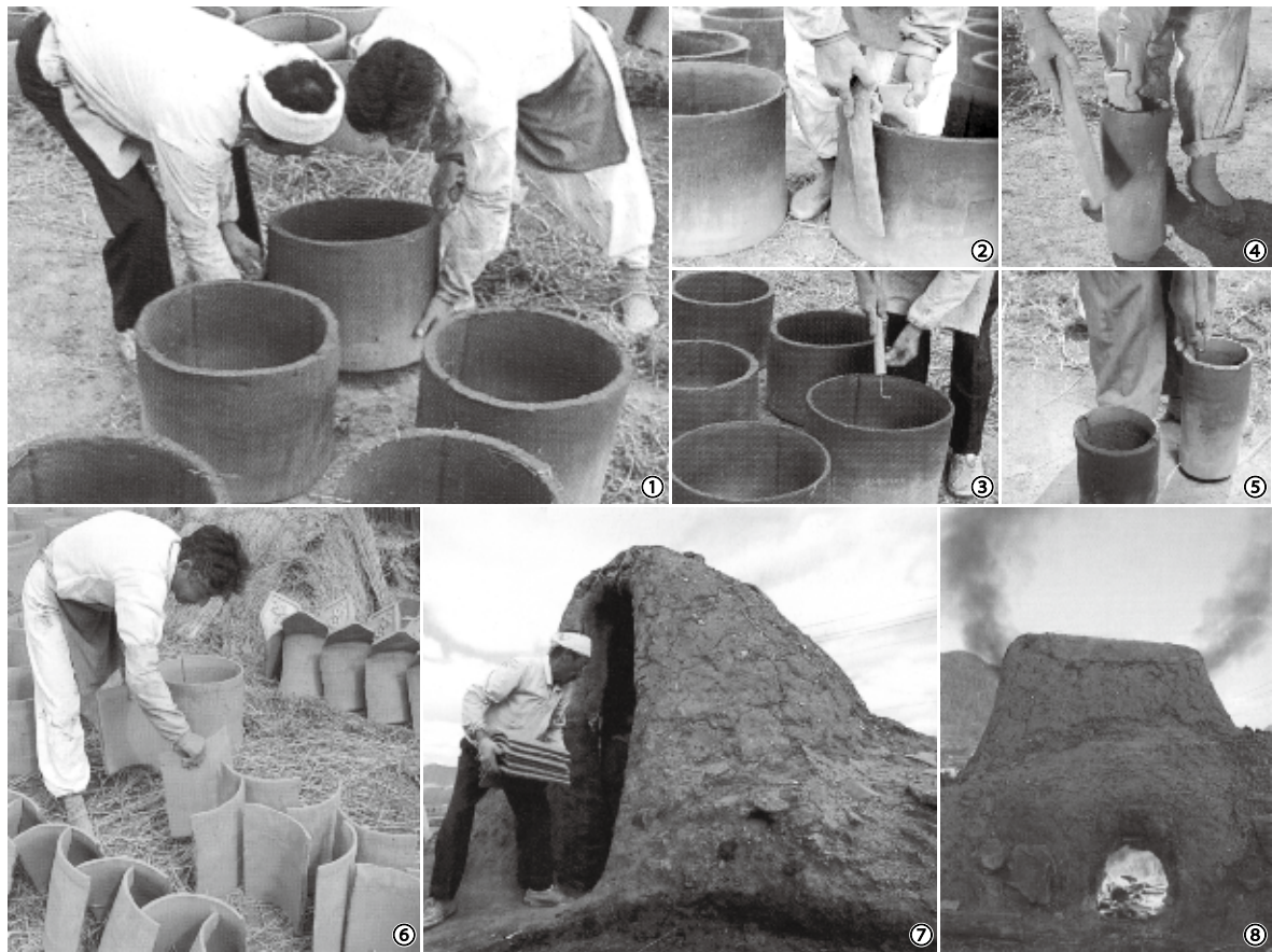
図2 「製瓦匠」韓亨俊氏の製作工程2 (『製瓦匠』1996)
