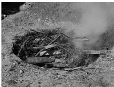
【写真 19】 8:40 ~ 檜の枝を投入する。水分があったためか白煙があがる。白煙は主に水蒸気と考えられる。
