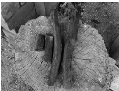
【写真 26】 材の中心部まで炭化（黒色化）していたもの。
