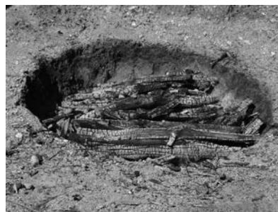
【写真 20】 9:45 ~ 残りの材を全て投入する。 10:20 ~ 全ての材に火が着いた(写真 20)。
