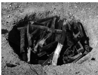
【写真 18】 8:25 ~ 檜の枝をオキにして松材を投入する。
