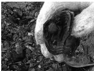
【写真 25】 2 回目の実験でできた炭の内部。材の中心部は褐色で生焼けであった。
