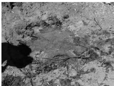
【写真 22】 12:00～ 上端の材が燃えきって火が消えたようなので、中央部分の穴に檜の葉を乗せて砂を被せて完全に穴を塞ぐ（写真 22）。しばらくこのままの状態に放置することにした。砂を被せて酸素の供給を断つ。 ※酸素を遮断した状態で加熱することにより炭化が起こる。
