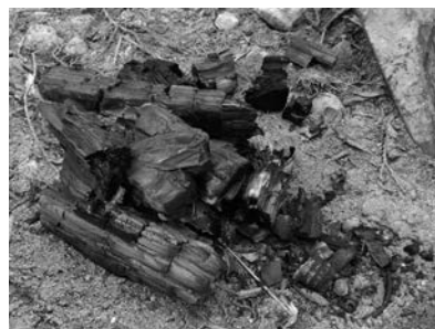
【写真 24】 上に乗っている砂と檜の葉を取り除く。上部の太めの炭材を取り上げ、下部のオキと思われる小さな材を掘り出す。底の方は部分的にまだ赤く燃えており、パチパチと燃える音がしている（写真 24）。高木田氏によると、煙道付きの炭焼窯でも、炭を取り出すとパチパチと焼ける音がするとのことである。 安全のため水をかけて消火した。
