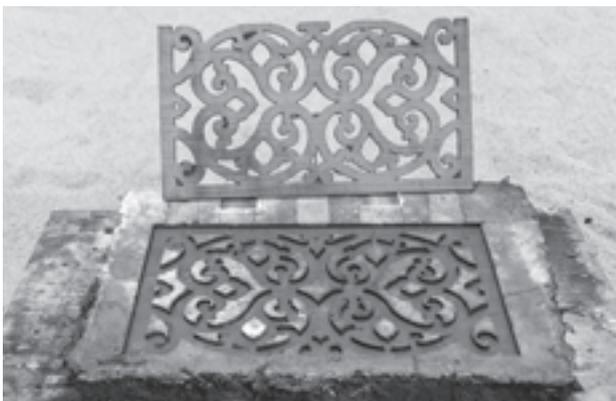
図9 朴原型を用いて製作した真土型
