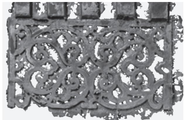
図12 金型の原型による真土型で鑄造した地金
