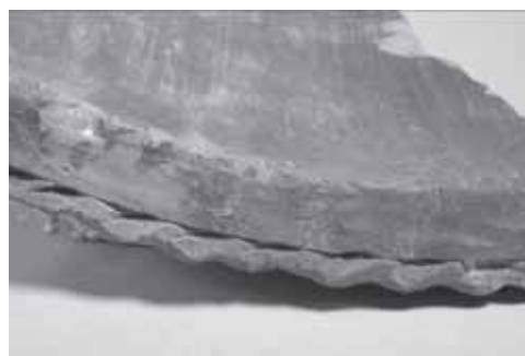
瓦表面に見える液だれの跡
