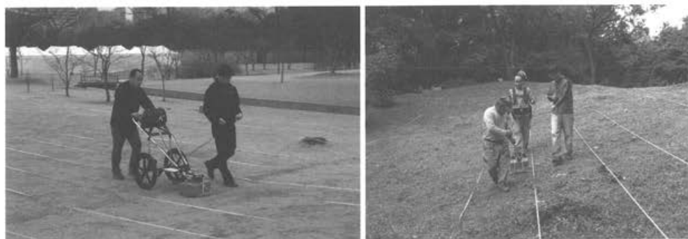
第4図 カート (cart) を利用した GPR 探査 (左)、補助探査者を活用した GPR 探査 (右)
