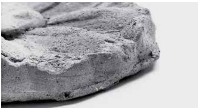
4 栴型端の粘土のはみだし (B種)。
