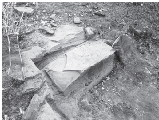
図27 溝切技法による採石状況
