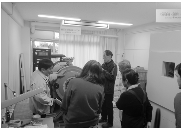
写真6 安定化処理作業（真空凍結乾燥）
