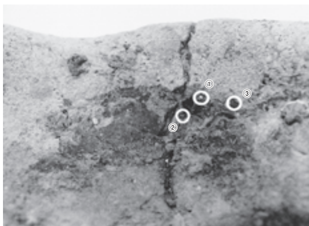
図81 坩堝（取瓶）の熔結付着物と分析部位
