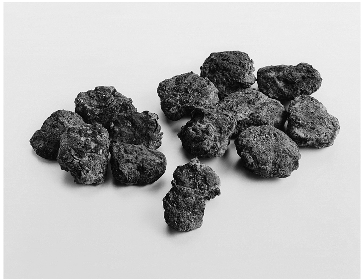
図198 梔形鉄滓 (手前：小型、左奥：中型、右奥：大型)
