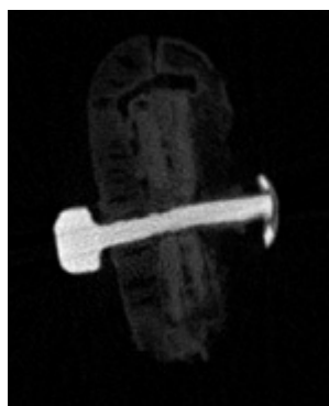
図44 目釘部分のX線CT画像
