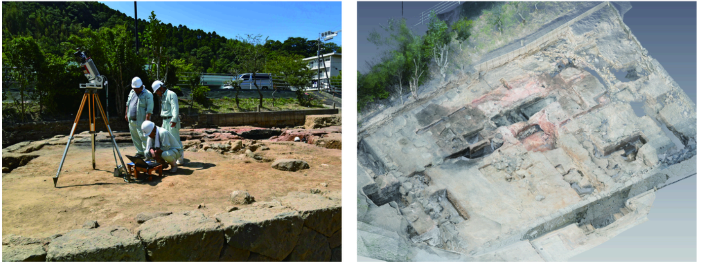
図2 越堂たたら跡の3次元測量の様子（左）と点群データ（右）
