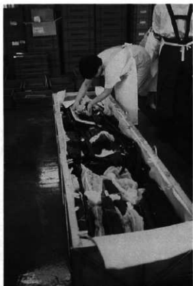
① P・E・G処理槽への漬け込み作業
