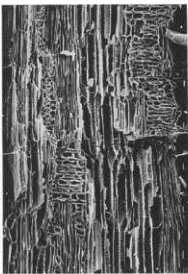
4c ケヤキ (放射断面) 試料9 bar: 0.1mm
