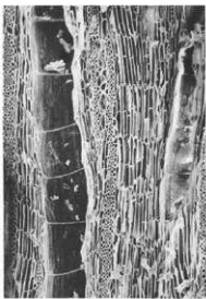
4b ケヤキ (接線断面) 試料9 bar: 0.5mm
