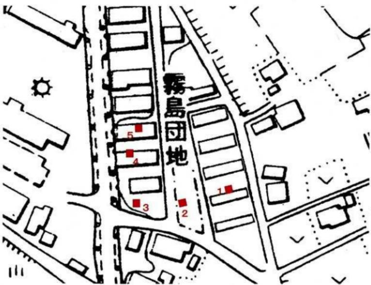
第9図 工事予定区試掘坑配置図
