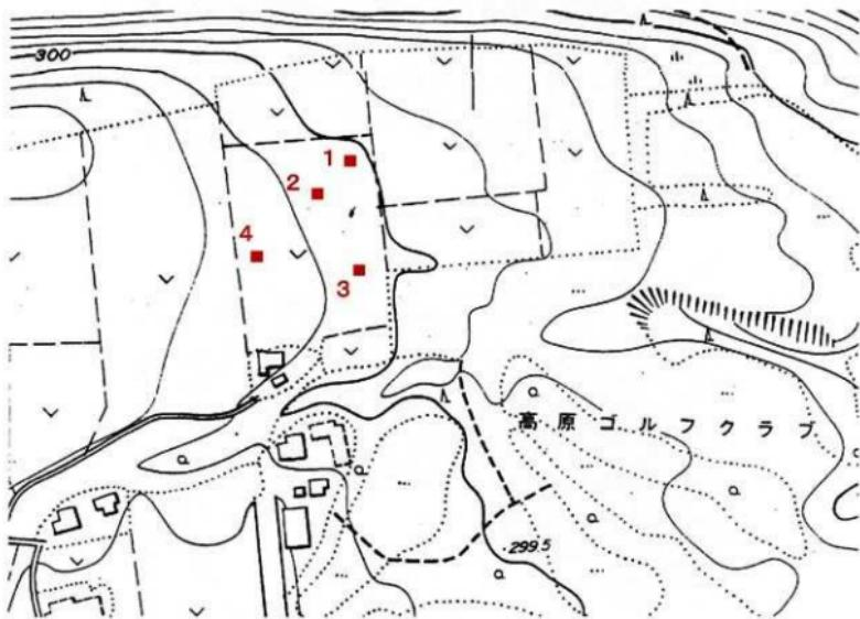
第5図 工事予定地試掘坑配置図
