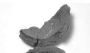
破断面にある圧痕
