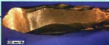
194 槍の折れ面 (写真の幅=4cm;実物の1.75倍)
