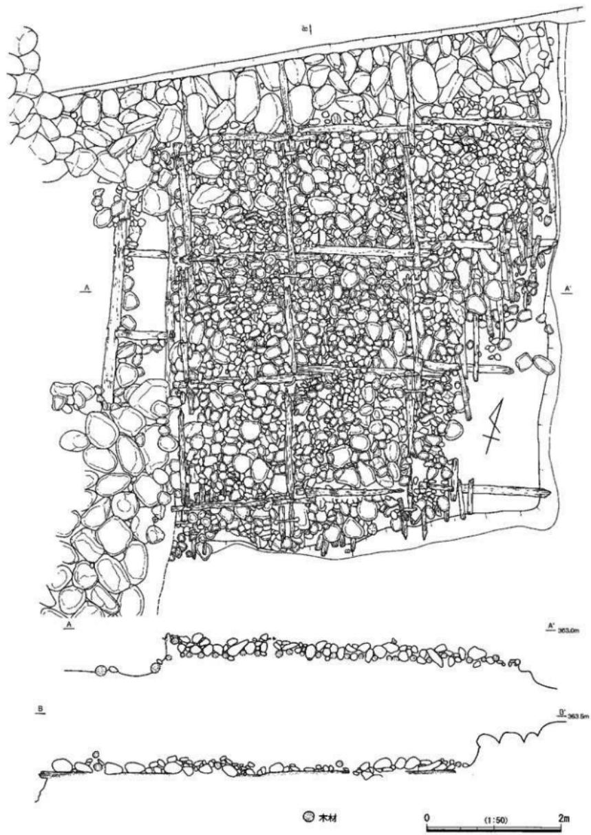
第19図 木工沈床玉石面平面図
