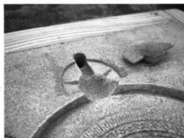
図版 21 鈴部分のガス抜き孔
