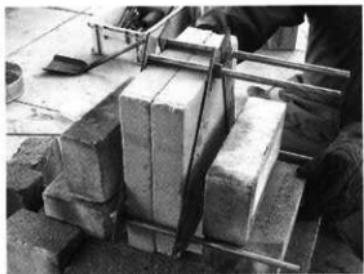
図版 37 鈴鏡縦置き鋳型を湯口から加熱
