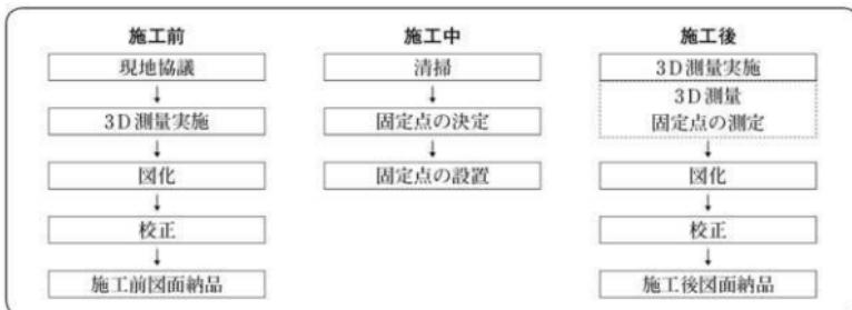
図5-2-3 測量作業の基本的な流れ
