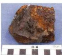
写真10 硫化鉱 (O-6) B地区外北東隣接地、表採。
