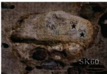
写真5 SK60を充填した土鉱 (暗灰色、硫酸鉛鉱O-1:黄褐色、鉛ジャロサイトO-2)。
