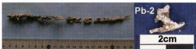
写真3 鉛滴(Pb-2) 全体の形(左)と分析試料(右)。大部分は白鉛鉱化。内部に灰色の鉛が残る。
