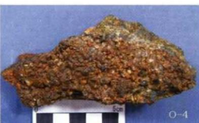
写真8 酸化鉱 (O-4)。スコロド石、硫砒鉄鉱、方鉛鉱、硫酸鉛鉱、鉛ジャロサイトなどの混合鉱石。
