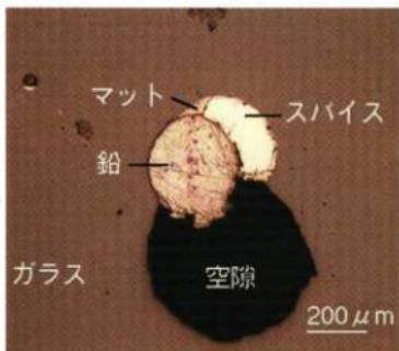
写真18 スラグS-1の反射顕微鏡写真
