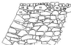
第89図 (No 7) 鉄門石垣・番付け図・控え分布図
