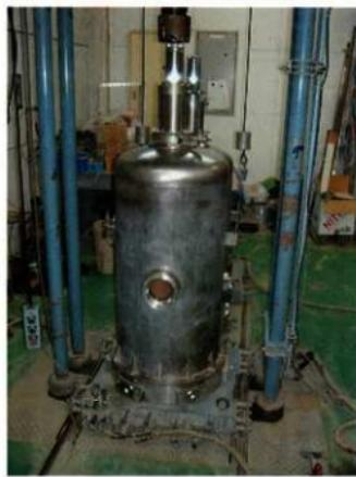
写 8-3-8 大型三軸圧縮試験状況
