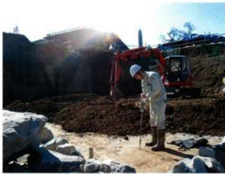
写 8-3-10 施工管理（簡易貫入試験状況）
