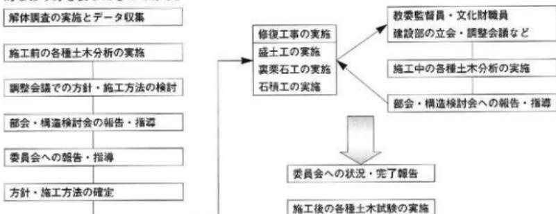
図7-1-1 改修工事の基本的な流れ
