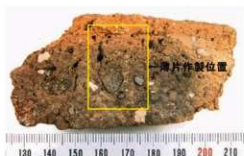
2. 土壁の断面 (SH320)
