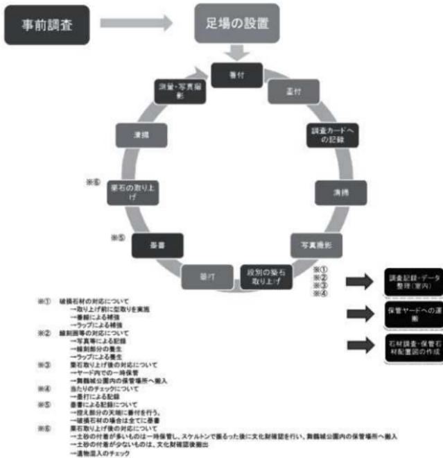
図 II 2-2-9 石垣解体工事手順サイクル
