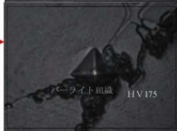
写真 4 硬度測定写真
