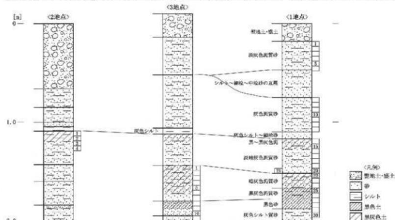
第4図 1～3地点模式柱状図および試料採取位置
