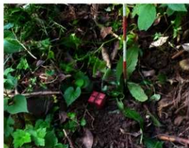
写真 5-12 境界杭(プラスチック)
