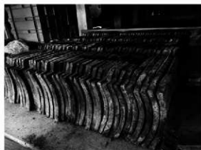
既存棧瓦 打音検査合格瓦 一八四枚
