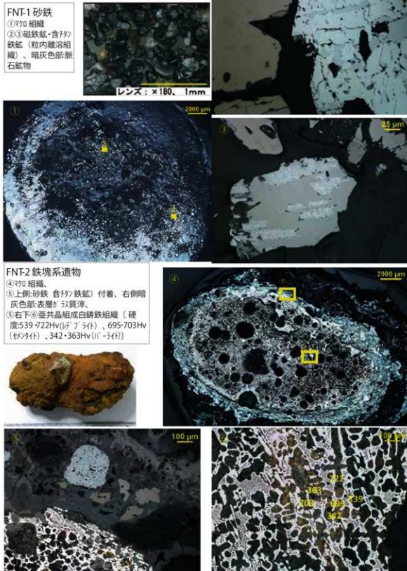
写真 14 砂鉄・鉄塊系遺物の顕微鏡写真
