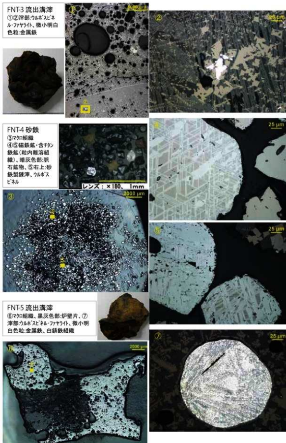
写真 15 流出溝滓・砂鉄の顕微鏡写真
