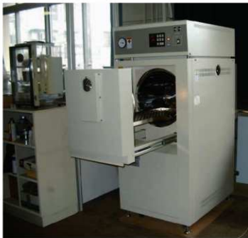
写真2 脱塩処理装置
