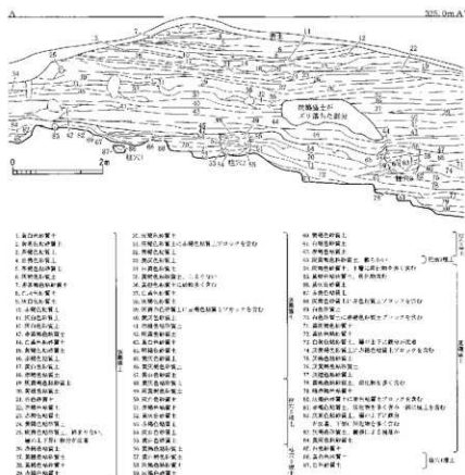
Fig.17 大石垣上方地区C区土層崩落部土層図(1/90)(福岡県教育委員会 2010 から転載)
