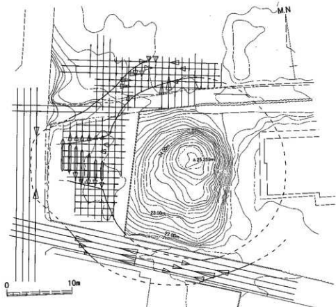
Fig. 95 地中レーダ探査による特徴分布と墳形推定図
