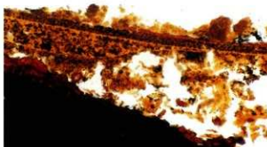
3 短甲覆輪の塗膜断面
