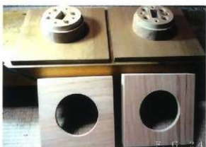
F, G人形（童子・玄翁和尚）の台車 台車枠組みの天板と枠（箱状の側面）はヒノキ を実物と同様に使用したが、下部の板には重量 が掛かる為、割れ易い事を考慮して、今回はサ クラを使用した。
