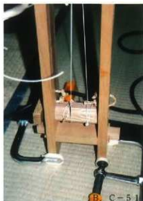
B人形（忠信）の台車下 人形の前傾と反りの動作の系の 巻取り軸。
