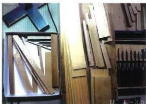
H. I人形（藤太・弁財天） 胴 2体分の胴体使用するサクラやカシの素材を用意して再確認をしている所。 ヒビや虫害の無い事をチェックする。
