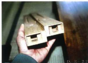
D人形（玉藻之前）の台車 枠組の木口部の細工。押し台側との連結の事を考慮して、寸法には細心の注意を払う。他の横遣いの台車とは形状が異なる部分。
