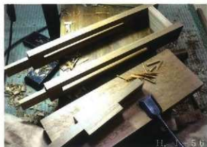
H人形（藤太） 立棒・支柱製作 台車下部の支柱を製作している様子。 素材はサクラ。 以前新調した忠信人形と良く似ている。
