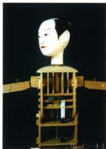
B人形（忠信）の上半身 仕上がった頭を胴体に載せる。 この時に滑らかに首が回るか、 ゼンマイバネの強さを調整。 忠信の髪はカツラではなく、 直接頭に植え付ける。 素材は人毛。
