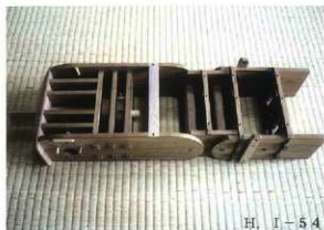
H人形（藤太） 胴体 糊を入れて接着が済んだ様子。 後はバネ類を取り付けるのみとなった胴体。
