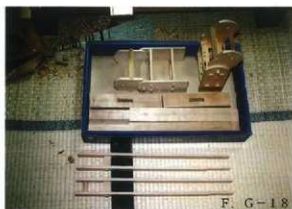
F. G人形（童子・玄翁和尚）の胴体 胴体と共に立棒（支柱）も作り始める。台車下 の立棒はサクラで作、人形側はカシで作る。
