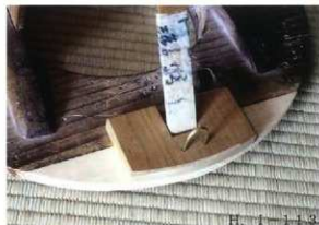
I人形（弁財天） 台車 バネの固定部分。修理が完了した後。 釘による固定方法は行わなかった。
