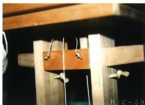
B人形（忠信）の台車下 人形の立棒の固定方法。 2本のピンの抜き差しで、確実に固定と 脱着が出来る。
