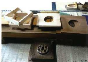
F, G人形（童子・玄翁和尚）の台車 枠はヒノキ、下の板はサクラを使用。 全ての寸法が歪みの為（一部割れ）、 バラバラであったので、平均値を出し製作。
