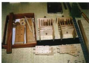
F, G人形（童子・玄翁和尚）の胴体 先に組んでおいた胴体に軸芯やゴマ（円板）を 仕組んで見て動きや隙間の具合を確認する。
