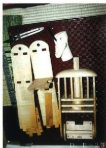
D人形（玉藻之前）胴体組込 首の軸等を通して見て、円滑に動作する事を確認する。
