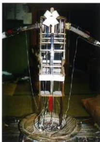
正面から見た様子 本来のクジラバネが使用して ある部分と、銅に替えられて いる所がある。材料の入手が 困難だったと推測出来る。
