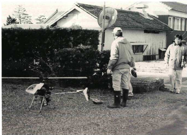
(1) 空中写真測量のためのラジコンヘリコプター
