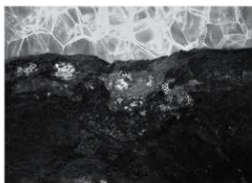
7. 加工痕 鏡面側斜めから [50 倍]
