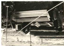
土壌の周囲をスチレンス枠の大きさに削る
