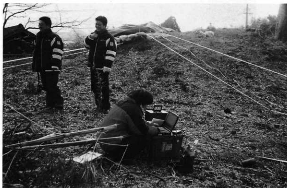
測線1のGPR測定状況
