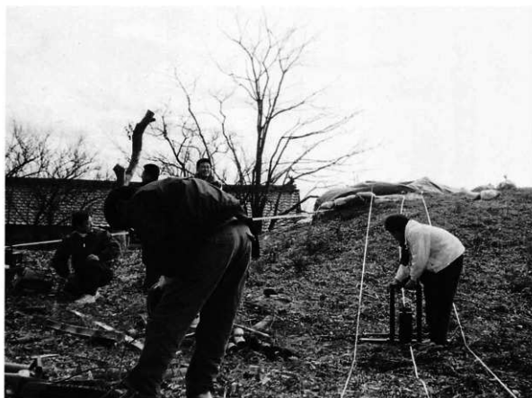
測線1のGPR調査状況（道路から御霊塚古墳へ）
