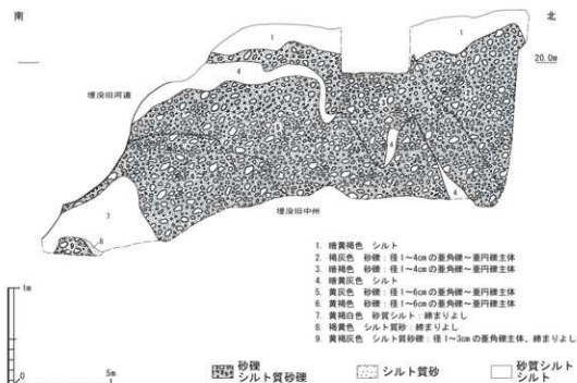
第4図 D地区におけるトレンチの地質断面図
