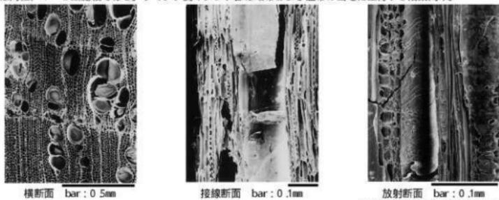
炭化材の走査電子顕微鏡写真（1）
