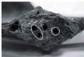
Fig.115 ICP 発光分析用使用採取部分
