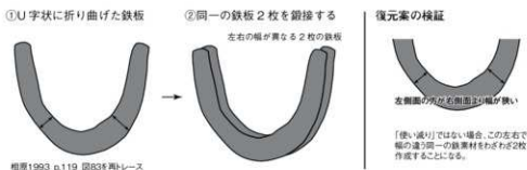
図8 麻生小学校南遺跡第2号住出土U字形鉄鋤先の製作復元案の検証
